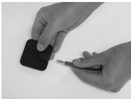
Rysunek 3.3 Sposób podłączania elektrod
