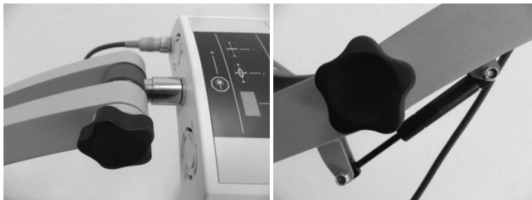
Rysunek 3.6 Pokrętła blokujące skanera i ramienia statywu
